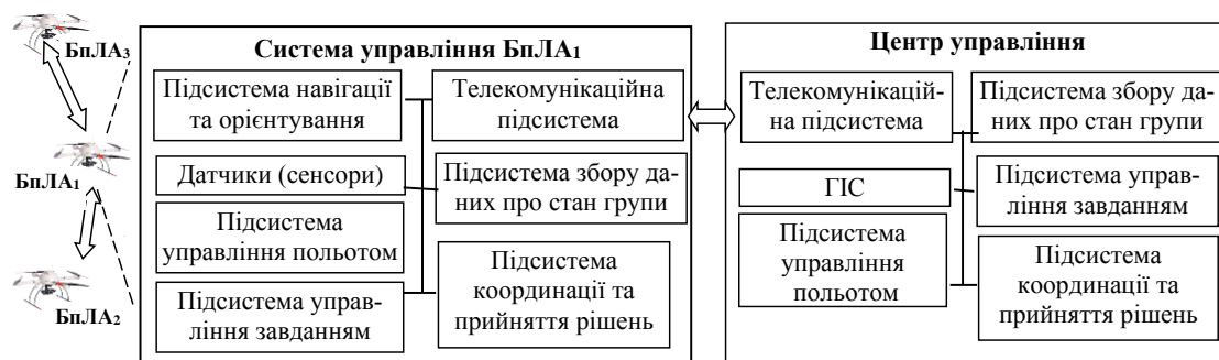
Рис. 1. Функціональна модель системи управління групою БпЛА
