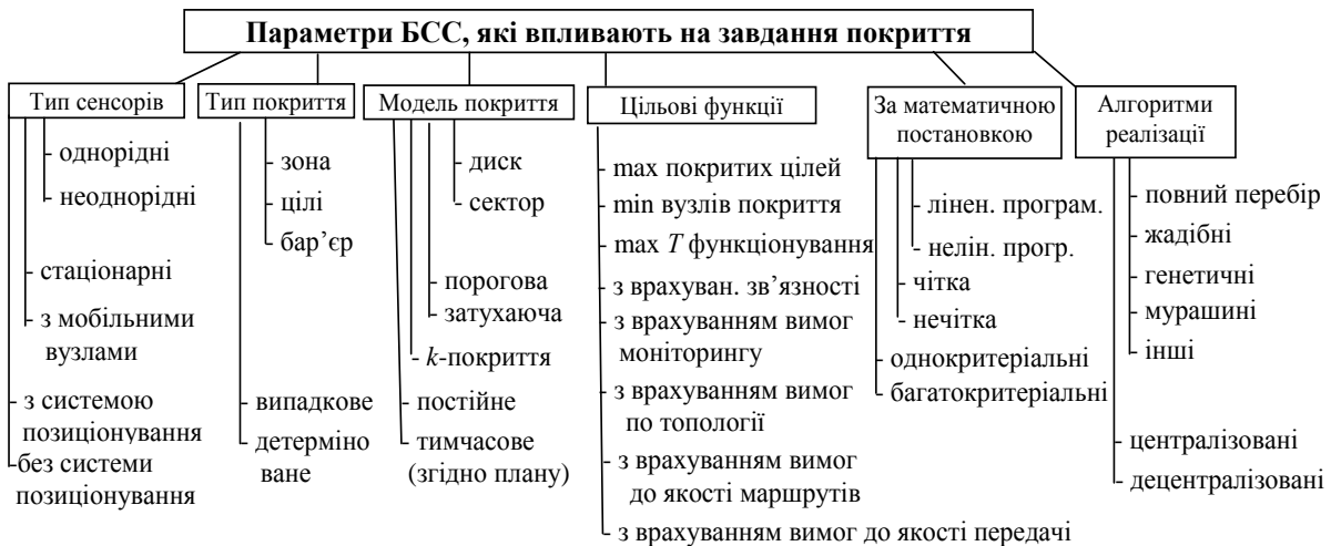
Рис. 1 Параметри БСМ, які впливають на завдання покриття
