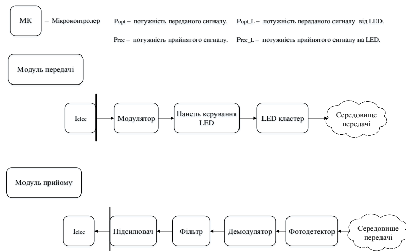
Рис.8 Деякі пояснення до аналітичної структури мережі Li-Fi
