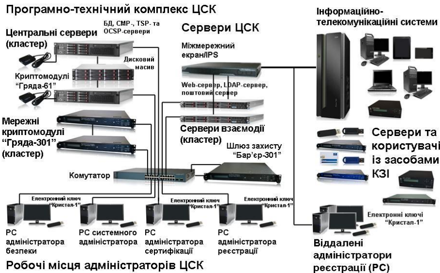
8 – Структурна схема комплексу технічних засобів АЦСК
