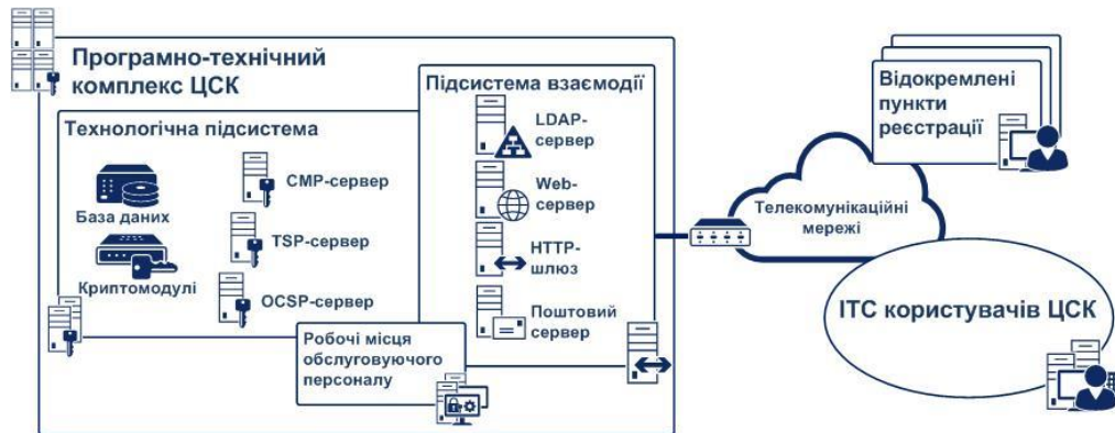
Рисунок 6 – Функціональна схема комплексу
