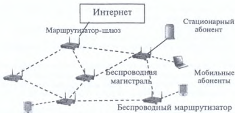
Рис. 1.7. Вариант беспроводной ячеистой сети
