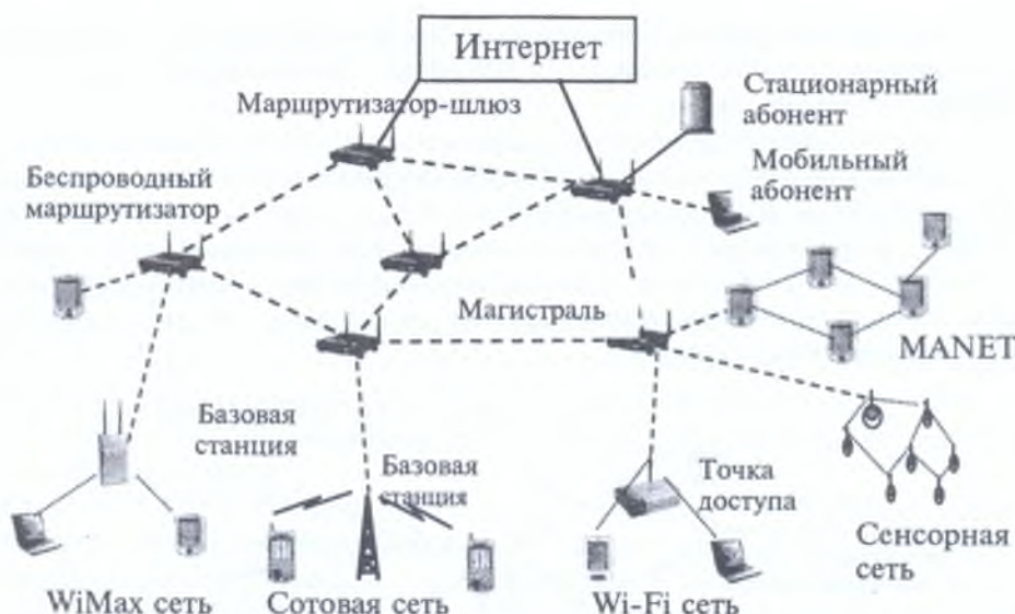
Рис. 1.9. Вариант построения гибридной ячеистой сети
