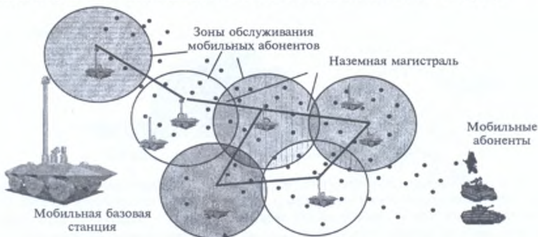
Рис. 1.4. Сеть мобильных базовых станций (самоорганизующаяся радиосеть 2-го уровня)
