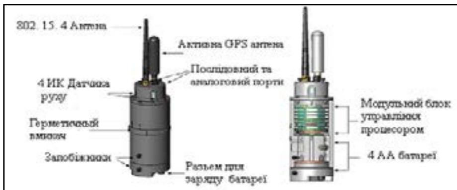
Рис.1. Конструкція наземного тактичного сенсорного вузла (вузол чатовий)
