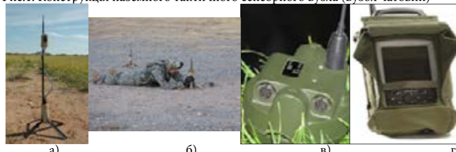
Рис. 2. Приклади наземних сенсорних вузлів: а) оптичний вузол-сенсор; б) багато параметричний вузол-сенсор (виявляє транспортні засоби, людей, літаки); в) вузол-шлюз; г) безпроводний контролер
