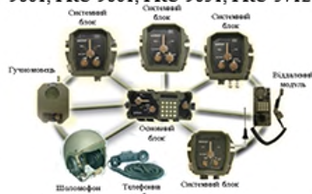
Рис. 2. Апаратура внутрішнього зв'язку та комутації місця можна управляти однією з них (як виробництва „Aselsan”, так і інших виробників).
